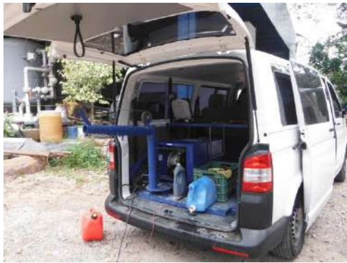
Equipamiento para videograbación del pozo.
