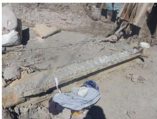
Muestra de suelo en el sitio de perforación del pozo.
